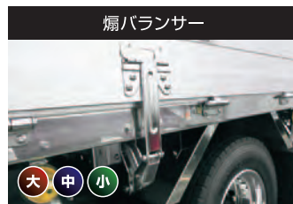
中柱部ウィングロック・補助ロック付煽ロック
