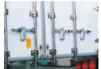
ロックンバー2対 拘束力が高まりボデー強度、耐久性を高めます。バー及びドアフレームステンレス製は別オプション。
