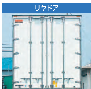
リヤドア 写真はコルゲートパネルタイプ大型車 金具のステンレスはオプション。 (軽量フラット大型はヒンジ4対となります。)
