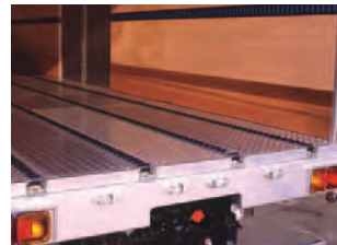
リフトローラ(エアリフト式) パレット全体を15ミリ程度浮かせ前後に移動できます。油圧式もあります。
