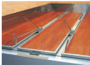
パレットローダ バー操作によりパレットを10ミリ程度浮かせ前後に移動できます。
