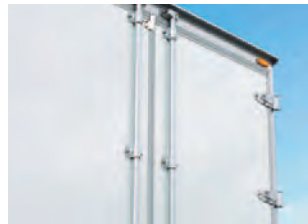
カラーアルミ外板 カラーアルミ外板にすることで美しく、イメージを高めます。また耐食性にも優れます。
