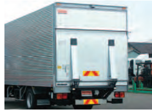
跳ね上げ扉+テールゲートリフタ 扉がひざし代わり、ゲートが扉を兼ねるので、作業もはかどります。
