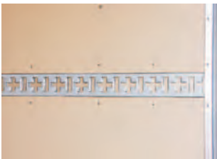
ラッシングレール(+I型) 縦向き、横向き自由にベルトが使えます。
