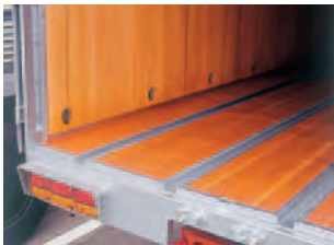
パレットローダレール パレット製品の積下ろしには不可欠です。
