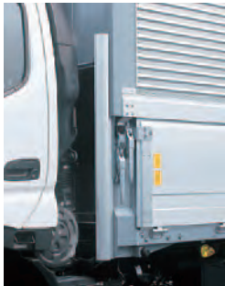
フロントコーナプロテクタ (アルミ製一体型)
