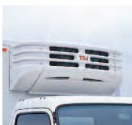
前壁一体型冷凍機 (菱重製)
