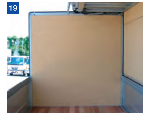
前内板 9t耐水合板張り
