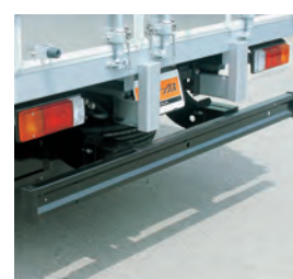
リヤステップ滑り止め付 (ターミナルストップは別オプション) (テールランプ吊下げはオプション)
