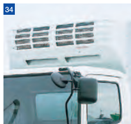
前壁一体型冷凍機 (デンソー製)
