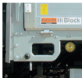
フロント補強(ステップ兼用) およびヒンジ
