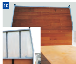
前壁全面張り (アルミ+アビトン)
