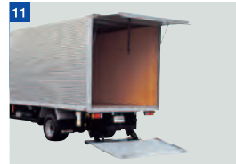
リヤドアはね上げドア式 (ゲートはスイングアーム式)
