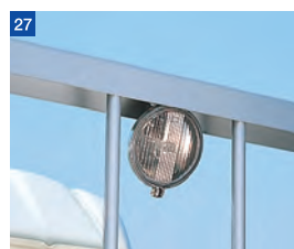
作業灯(前壁上方)
