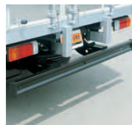
リヤステップ滑り止め付 (ターミナルストッパは別オプション) (テールランプ吊下げはオプション)
