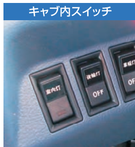
シーソー型埋込 ダッシュボードにスッキリ収まり操作 性にも優れます
