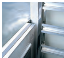
あおり上面の断熱構造
