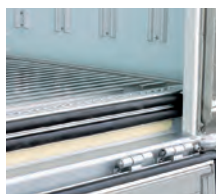
床と煽りの断熱・気密構造 (コールドS)
