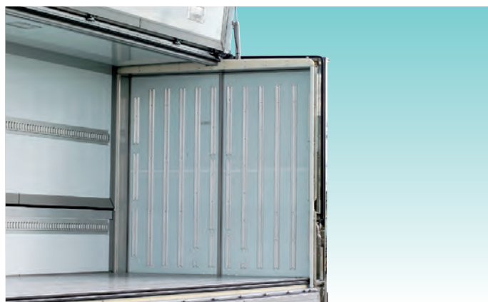
●エアリブ付でサーキュレーションにも配慮されたリヤドア。
