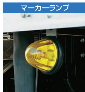
丸型黄色 5対装備で安全走行が図れます
