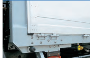
スチール製両端ダブル内巻ヒンジ (ダブルは大型のみ)
