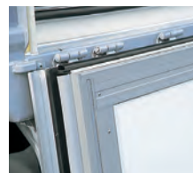
あおり周囲の断熱・気密構造
