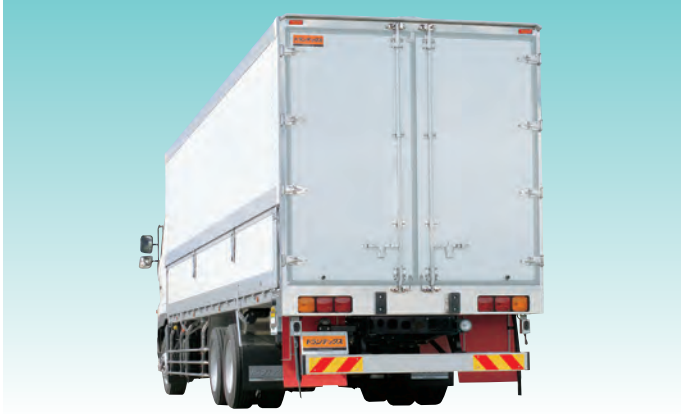
●リアドアフレームは開口拡大型で後方荷役優先方法です。 ●ドアフレームステンレス製はオプション。
