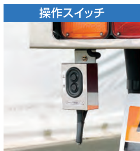
防水型 ステンレケース付 (側面操作に変更も可能です)
