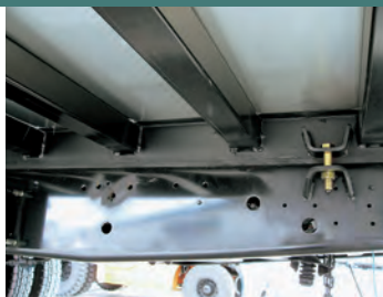
井桁構造 縦根太に横根太が貫通する構造(大型に対応) 超低床化と高強度を両立させます。
