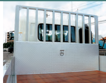
上部透かし張り 角型鋼管を追加した強化構造。(編鋼板張りとは中央フックは別オプション)
