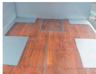
床鉄板でタイヤクリアランス確保
