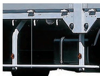
サイドバンパ(丸パイプ1段) 丸パイプ1段型とし軽量化をはかっています。
