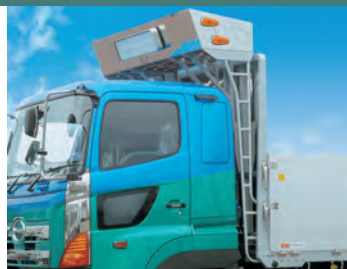
ポデー前シートキャリア 外板ステンレス傾斜型の例。(電装部品は別オプション)
