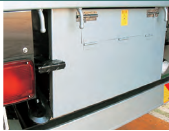
リヤ化粧板(スチール製) バンパ(ステップ)上面までの例。(フレーム間物入れ、補助ステップは別オプション)
