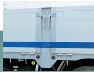
中柱(差込式) 側圧を支えると共に強度、耐久性にも優れます。
