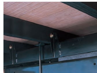
根太 積荷にやさしい木製の横根太、および剛性に優れたスチール製の縦根太を採用しています。
