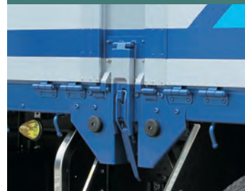
回転式 あおりと連動、三方開としても使用可能。 作業性、安全性に優れます。
