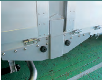
差込み式(アルミスカート用) アルミスカート仕様では中柱ガセットが大型化されます。
