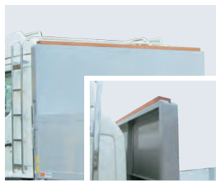
鳥居上枕木・前壁(鉄板張り)
