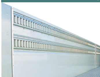
ラッシングレール埋め込み I型2段埋込みの例。 (中段取付は別オプション)
