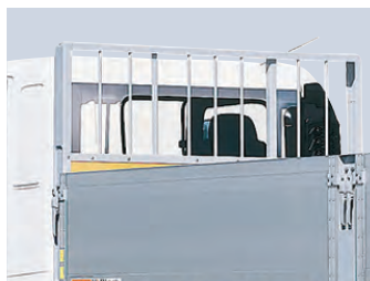
フロントウォール(鳥居) コーナピラーがストレート形状なので幌などの装着が容易です。
