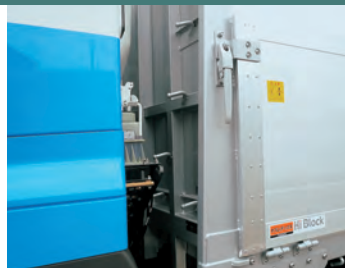
外部ロープ掛け ご要望により指定位置に追加。 最下段の2対(左右4ヶ)は標準取付。
