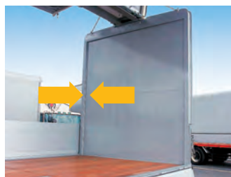
後門枠の段差40mmで最大開口長確保
