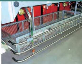
リング入れ(WB間縦向き) 5面エキスパンドメタル張り(サイドバンパスステンレスカパイ3段は別オプション)
