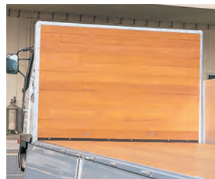
前壁全面張り(アビトン張り)
