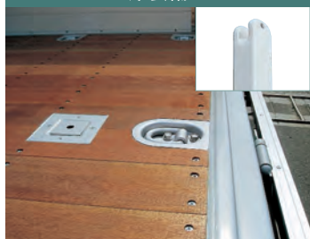
最後部床ポスト、丸環フック 幌シート張り用の床ポストを中央に設置。 (ロープ通し溝付ポスト 右上写真)
