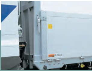
コーナービラー(大型) ストレート形状なので幌などの装着がとても簡単です。
