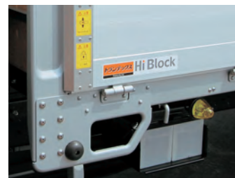
フロント補強およびヒンジ ヒンジは内巻式で安全性を高めながら荷台スペースも拡大
