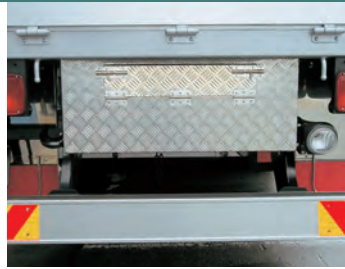
リヤ化粧板(アルミ編板製) シャシフレーム下面までの例。(フレーム間物入れは別オプション)
