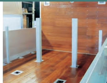
床ポスト 前方ずれ止めにはシャシフレーム外側に、横ずれ止めには床枠内側に設置します。
