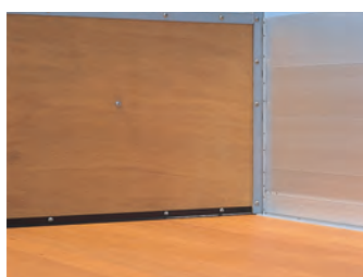
前壁合板・床材 積荷にやさしい前壁合板、床には耐久性に優れたアビトン材とし、汚れにくいニス仕上げです。
