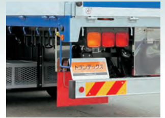
最後部泥除け EVA赤・ステンレス補強板付
