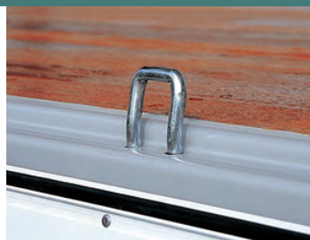
引出式フック(U型フック) 床面がフルに使えます。
