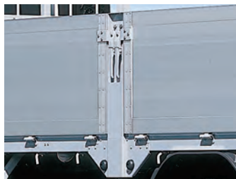
中柱 中柱、後柱共に差し込み式とし、堅牢さと耐久性を高めています。
