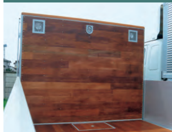
アビトン張り 作業灯、丸環フック埋込みの例。 (枕木、床点検蓋は別オプション)
