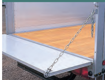
水平チェーン 後あおりを確実に支え、スペースも十分確保。
