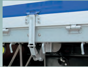
あおり開閉補助装置 スチール製2対(中型はなし)
