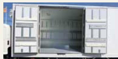
低温タイプの側扉全開時の外観。側扉は観音扉・前方先開き式（W=1800mm）。
