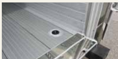
中温タイプの床はアンチスリップフロアタイプ
