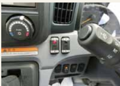
扉閉め忘れをお知らせする警告灯
