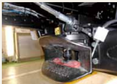
レバー操作式連結器（ヘルマウス）
