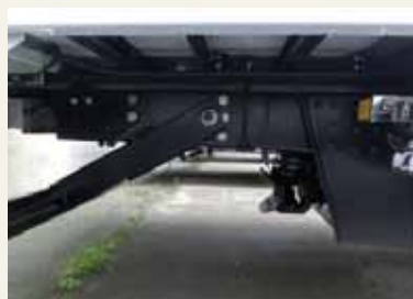
跳ね上げ式リヤバンパ（連結時は跳ね上げる）
