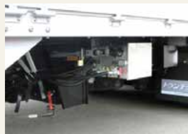
トレーラ側へのブレーキエアや電気の供給部
