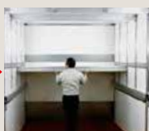
③デッキ中央下部の操作レバーで高さを調節する
