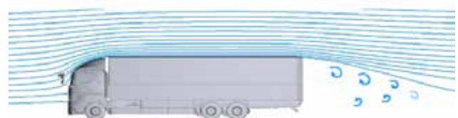
ボデー後方の空気の流れを改善し空気抵抗を低減
