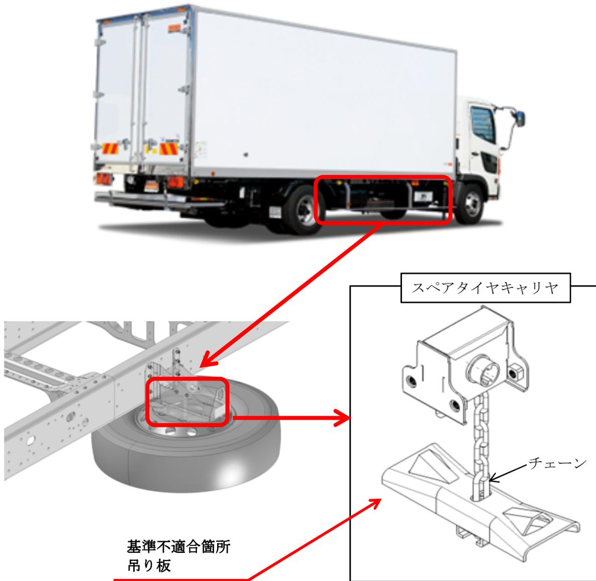
中型トラックの横吊り式スペアタイヤキャリアにおいて、吊り板の形状が不適切なため、当該キャリアにアルミホイール付タイヤを固定すると、走行中の振動でスペアタイヤが回転することがある。そのため、当該スペアタイヤキャリアのチェーンと吊り板が干渉して削れ、チェーンが破断し、最悪の場合、スペアタイヤが脱落するおそれがある。
