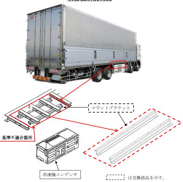
大型冷凍車のホイールベース間に取付けた冷凍機コンデンサ用マウントブラケットにおいて、設計検討が不十分なため、締結部に亀裂が生じることがある。そのため、走行振動などで亀裂が進行し、冷凍機コンデンサ用マウントブラケットが破断し、最悪の場合、冷凍機コンデンサが脱落し、他の交通を妨げるおそれがある。
